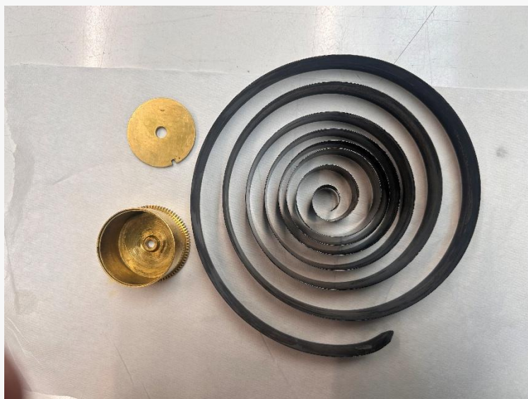
Photographie C6 - Ressort et barillet de la minuterie après nettoyage à l'isopropanol
