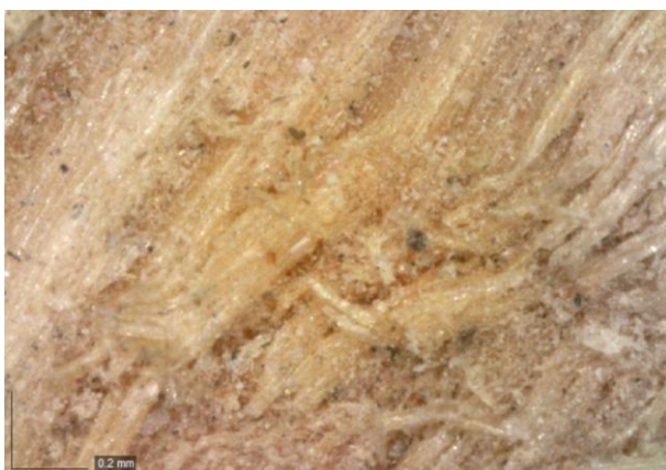
A001 coupe longitudinale, fibres diagonales bien visibles
