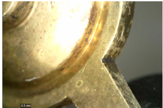
Figure 85 Roue de compte : après retrait mécanique de la corrosion
