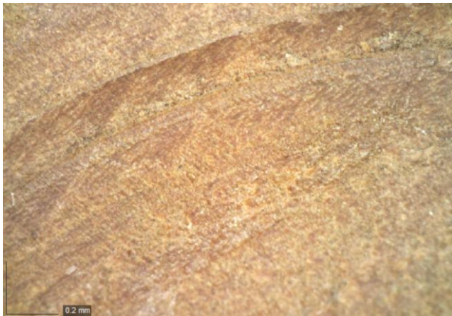
A004 coupe longitudinale, grain fin, fibres serrées, teinte brune chaude
