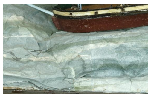
Figure 72 Doublage localisé de la déchirure
