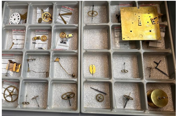
Figure 83 Mouvement horloger après démontage
