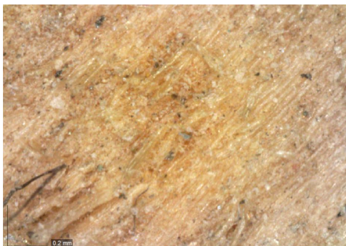
A003 zone avec bois de réaction ou intersection de fibres, teinte orangée plus intense au centre
