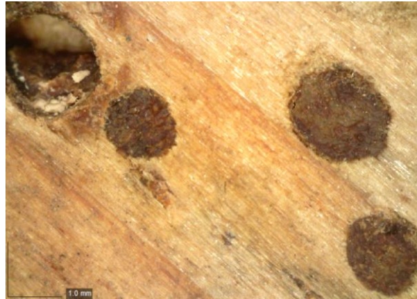
Figure 55 Revers du cadre sous microscope USB : trous d'envol comblés
