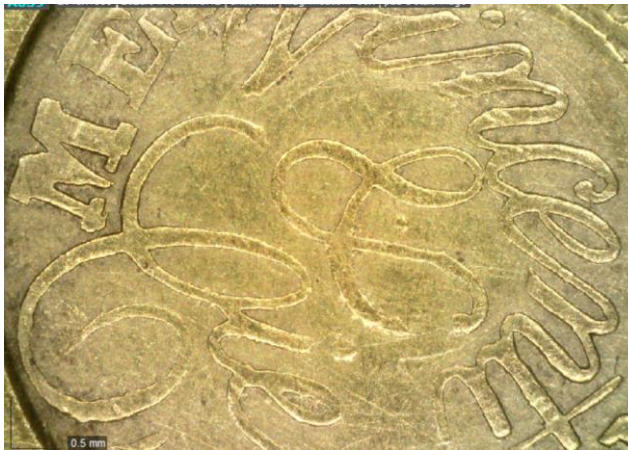
Figure 28 Platine arrière : poinçon sous microscope USB
