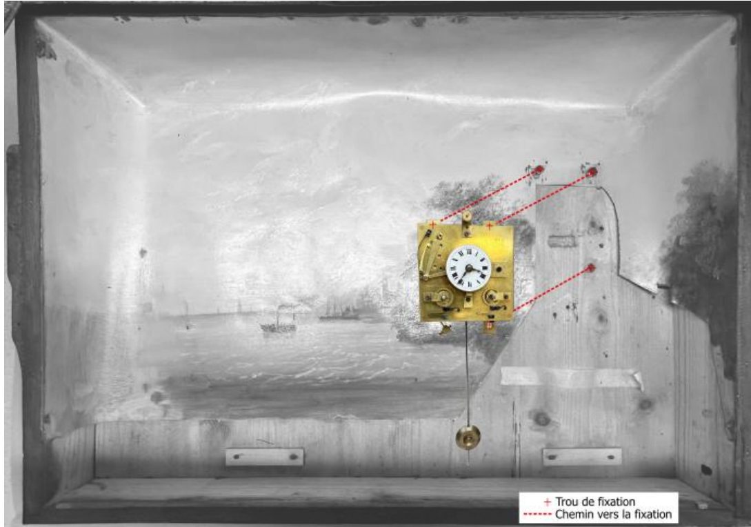
Figure 31 Schéma de fixation du mouvement horloger dans la boîte en bois
