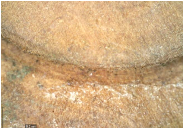
A005 Revers de la poulie A004; points verts (oxyde de cuivre ?) à la jonction
