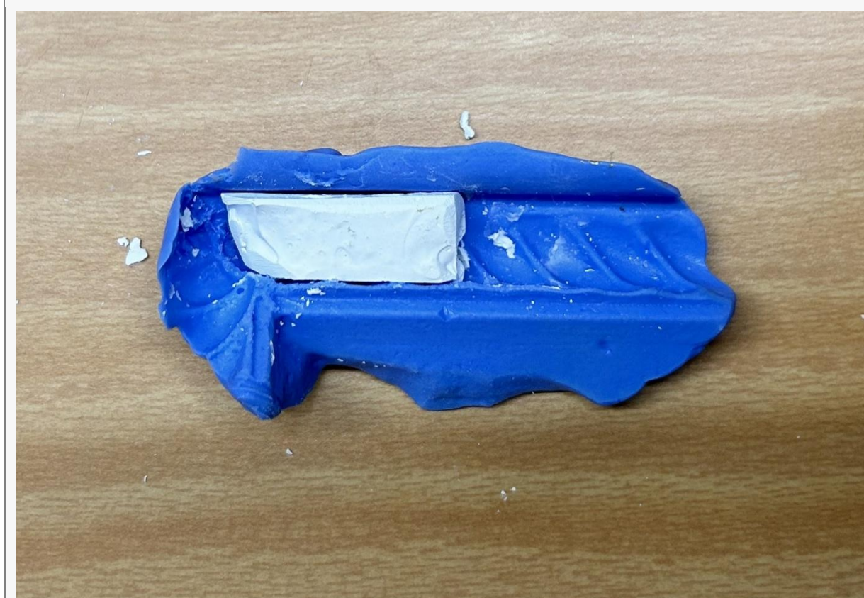
Photographie C2 – Comblement pour la lacune du cadre après séchage dans son moule
