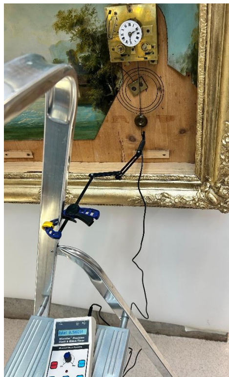
Figure 87 Contrôle de la vitesse d'oscillation du pendule
