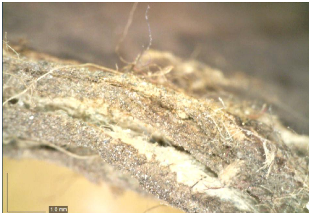
Figure 42 Décollement du papier multi-couche/carton sous microscope USB
