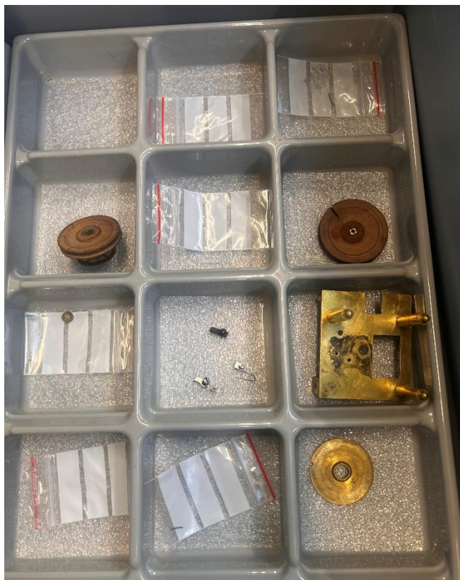
Figure 79 Mécanismes automates après démontage
