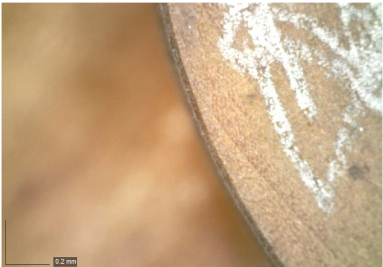
A006 vue de bord de la poulie ; à droite, surface avec dépôt de graphite
