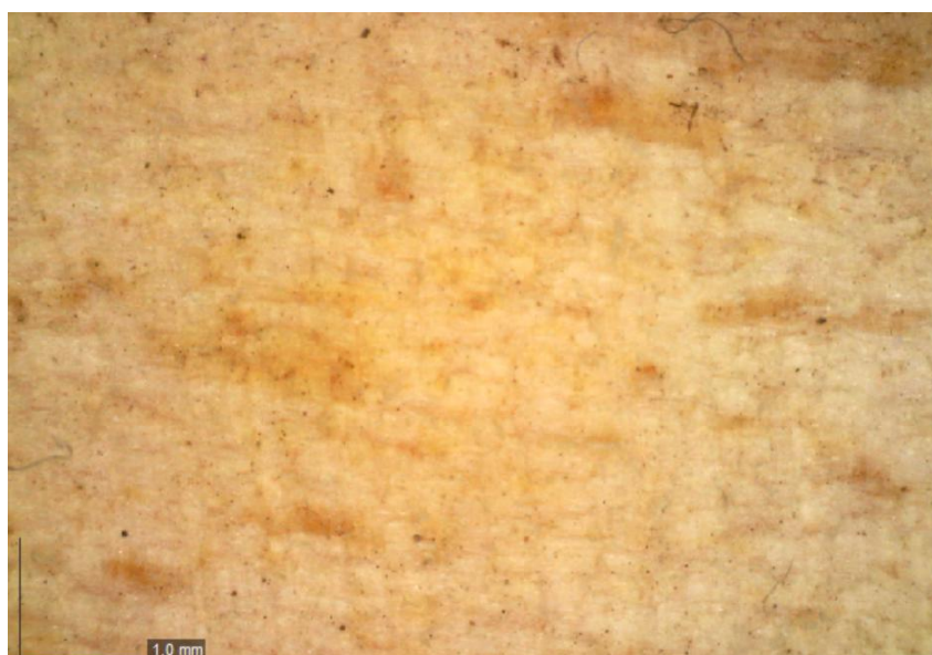
A021 zone bois nu ; texture cotonneuse très fine, fibre homogène, teinte crème-beige
